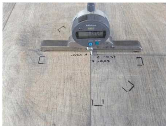
Figure 5 – Exemple de marquage des pieds de support de l'appareil de mesure
